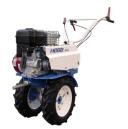
Мотоблок "Нева" МБ 23Б-10,0 производится с двигателем Briggs&Stratton мощностью 10,0 л.с. Продуманная конструкция и оптимизированные параметры двигателя позволяют задействовать его ресурсы с большей интенсивностью. Это повышает работоспособность мотоблока "Нева" МБ 23Б-10,0 при обработке тяжелых, уплотненных почв, а также целины.
